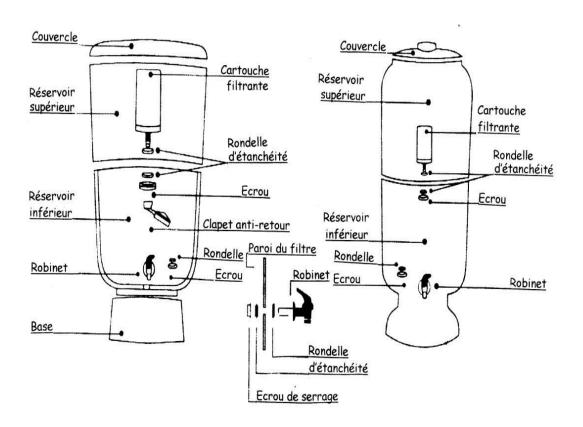
IMPORTANT : Lors du montage du robinet et du filtre, il est très important de faire tourner seulement l'écrou de serrage. Le blocage ne doit pas se faire en tournant le filtre ou le robinet.
