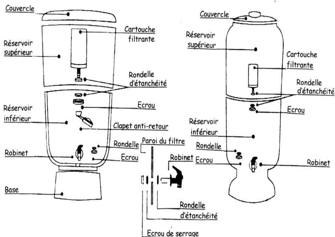
**IMPORTANT :** Lors du montage du robinet et du filtre, il est très important de faire tourner seulement l'écrou de serrage. Le blocage ne doit pas se faire en tournant le filtre ou le robinet.
