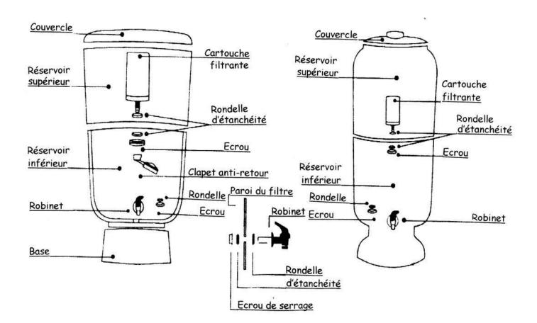
IMPORTANT: Lors du montage du robinet et du filtre, il est très important de faire tourner seulement l'écrou de serrage. Le blocage ne doit pas se faire en tournant le filtre ou le robinet. Vous pouvez voir le montage en vidéo en cliquant ici
